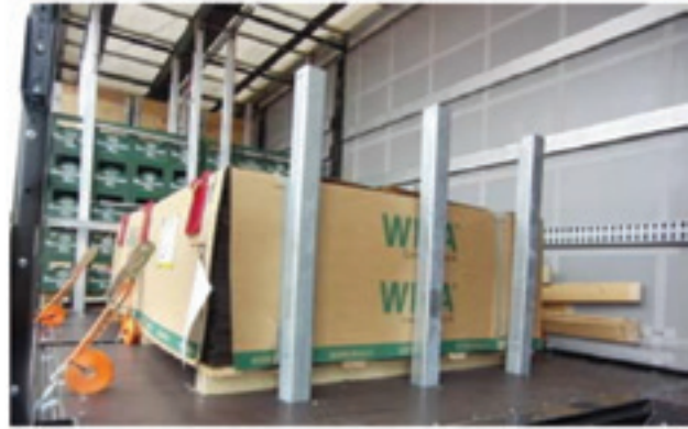
Joonis 7. Ettepoole liikumise tõkestamiseks kasutatavad vertikaaltoed
