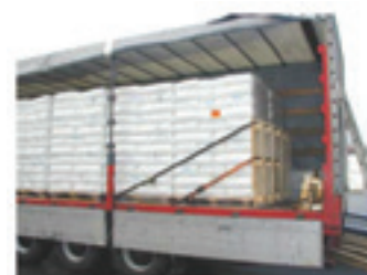
Joonis 39. Diagonaalside koos kaubaalustega
