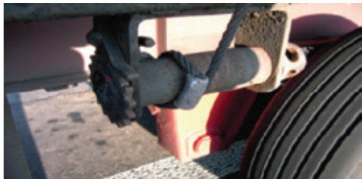
Joonis 24. Vintsiga pingutatud terastrossid
