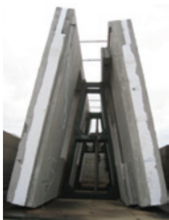
Joonis 46. Teisaldatav A-kujuline sõrestik
