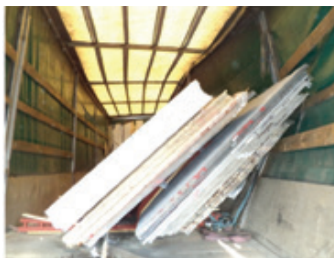
Joonis 45. Kokkuvarisenud A-kujuline sõrestik
