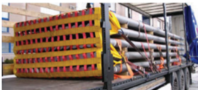
Joonis 32. Koormavõrgu ja otsese sidumisega kinnitamine edasisuunas
