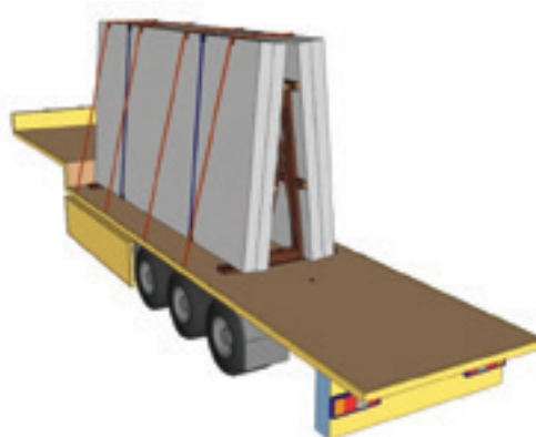
Joonis 48. Kinnitamine kombinatsiooniga: tõkestamine, A-sõrestik, ringside, pealt sidumine
