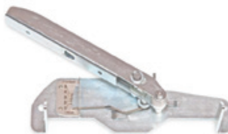
Joonis 23. Seade tõmbejõu mõõtmiseks
