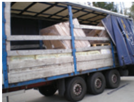
Joonis 19. Ebapiisav koormakinnitus ainult venitatavat pakkekilet kasutades
