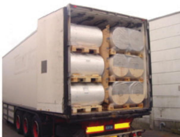
Joonis 28. Täitematerjal lastiridade vahel
