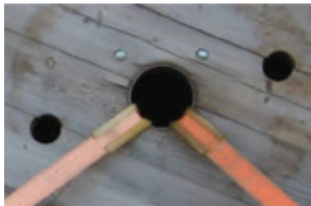
Joonis 22. Teravate nurkade kaitse
