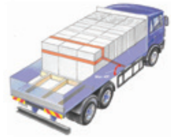
Joonis 40. Silmusega diagonaalside
