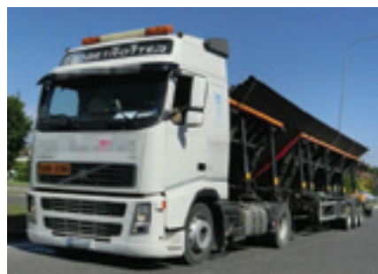
Joonis 14. Alla 45° transporditavad terasplaadid
