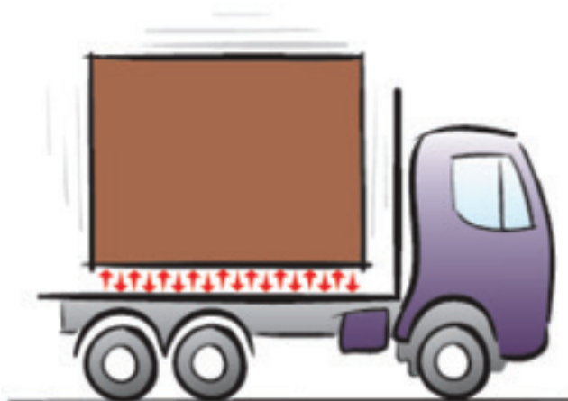
Joonis 3. Vertikaalne vibratsioon sõidu ajal
