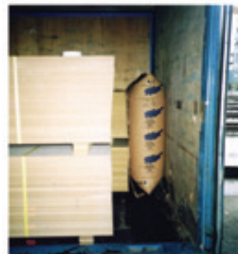
Joonis 29. Õhkpadji külje pealt tõkestamiseks
