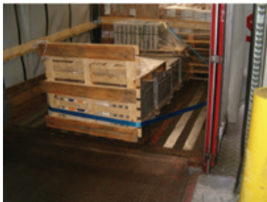
Joonis 75. Segaveose kinnitamine tagumisse osasse
